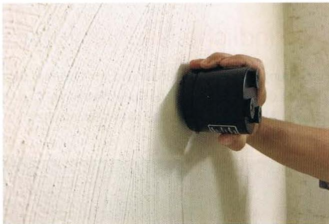
**Körperschall-Sender:** Mit der Hand wird der „Shaker“, das ist ein Körperschall-Sender, der eine Stahlnadel vibrieren lässt, auf den Wandputz gedrückt. Die vibrierende Stahlnadel wird direkt an das Mauerwerk angelegt. Dazu wird zuvor eine Unterlegscheibe mit Sekundenkleber auf den Putz geklebt. Quelle: ITA Ingenieurgesellschaft für technische Akustik mbH aus Wiesbaden.
